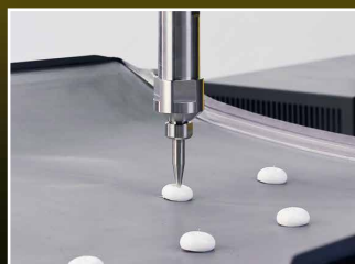
ドアパネルにマスチック シーラーを塗布
