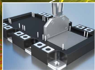
インバーターパワーモジュールに 放熱グリースを幅広塗布
