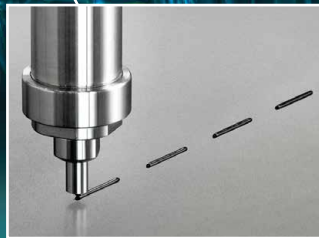
アンダーパネルに構造用接着剤を スティッチ塗布
