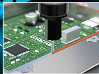
BMSに液状ガスケットを線塗布
