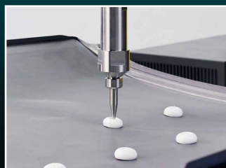
ドアパネルにマスキング シーラーを塗布
