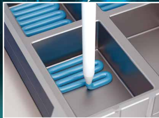
バッテリーケースに 2液性ギャップフィラーを塗布
